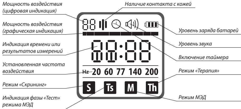
Рис. 4. Назначение символов на индикаторе аппарата
