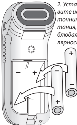
Рис. 5. Порядок замены источников питания аппарата ДиаДЭНС-Т
